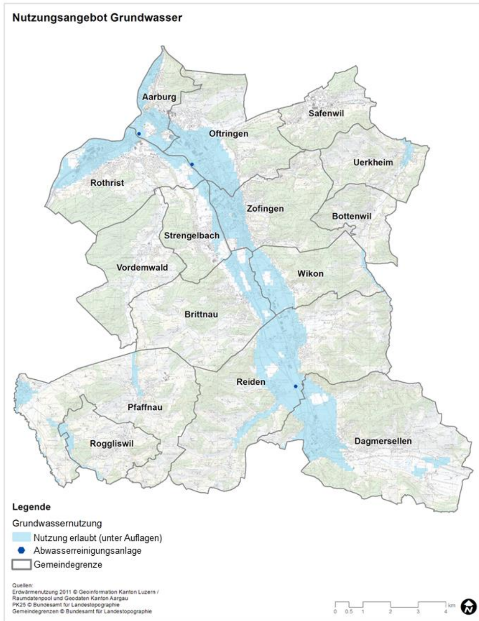
Abbildung 10: Eignungsgebiete zur Nutzung des Grundwassers mit Wärmepumpen
